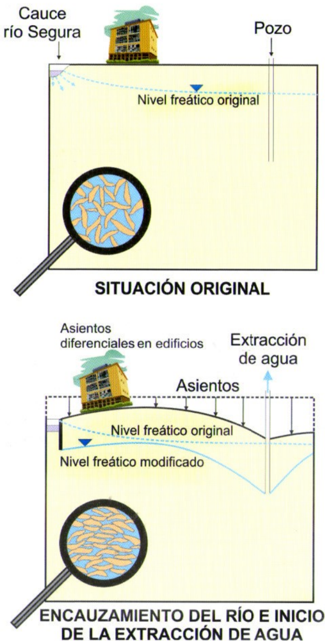
figura 36 - Esquema conceptual del origen de la subsidencia del terreno en la ciudad de Orihuela.
